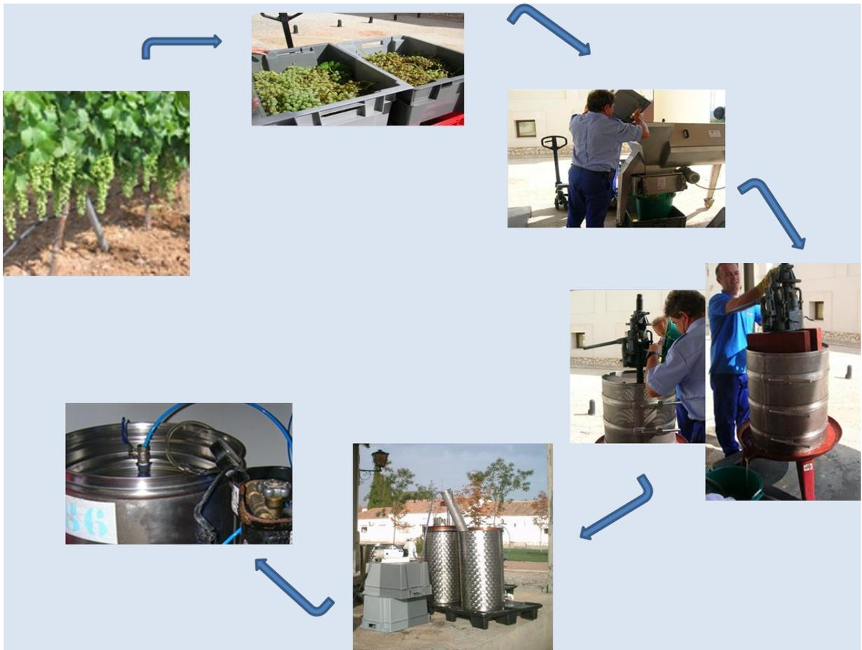
**Figura 2.** Procesamiento de las uvas y obtención del mosto en la bodega experimental de “El Encín”
