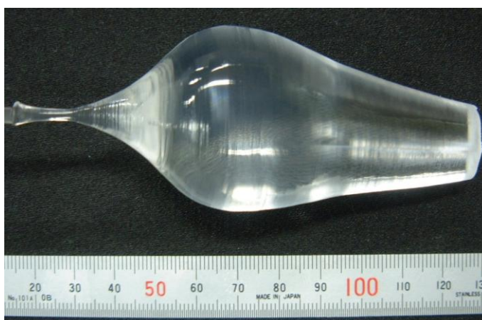
Figura 2. Fotografía del cristal \text{Nd}^{3+} :BMF crecido en el NIMS.
