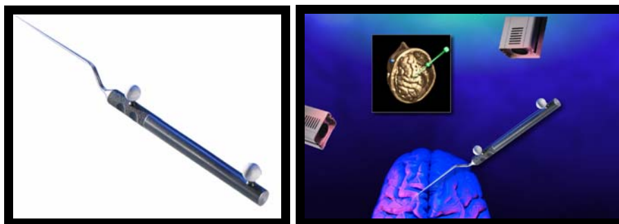
Fotos 35 y 36: Puntero con las esferas relectantes y esquema de la identificación del puntero en el espacio por el sistema óptico de posición.
