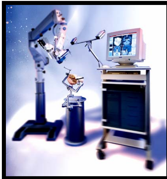
Foto 39: Sistema de Brainlab en el que se aprecia la estación de trabajo con las cámaras y el microscopio robotizado.
