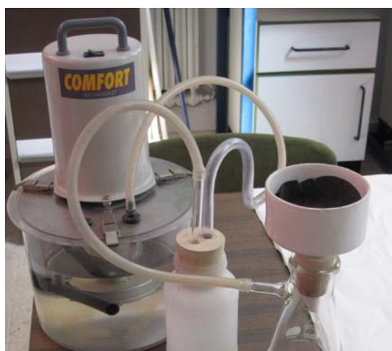
Figura MG-2. Bomba de vacío empleada para la selección de hembras adultas de B. tabaci .
