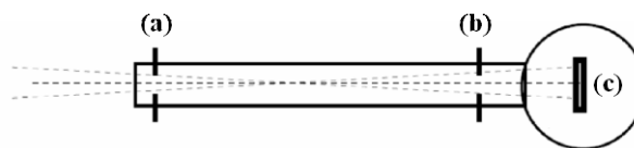
Fig. 1.5 Esquema del sistema de palas utilizado para la determinación del área de irradiación
