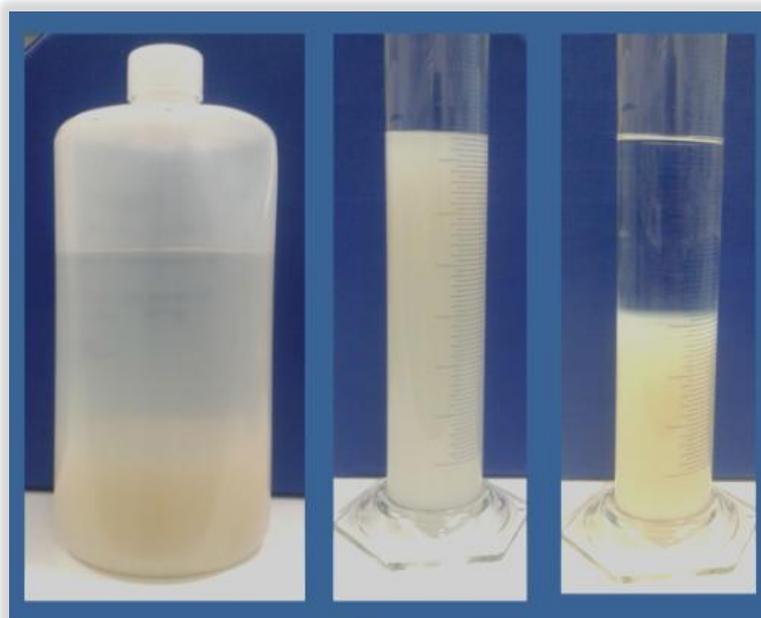
**Figura II.3.** Aspecto de una suspensión coloidal de mont.FEBEX-Na preparada para ensayos de adsorción. De izquierda a derecha: en botella, tras agitación y tras 48 horas de reposo.
