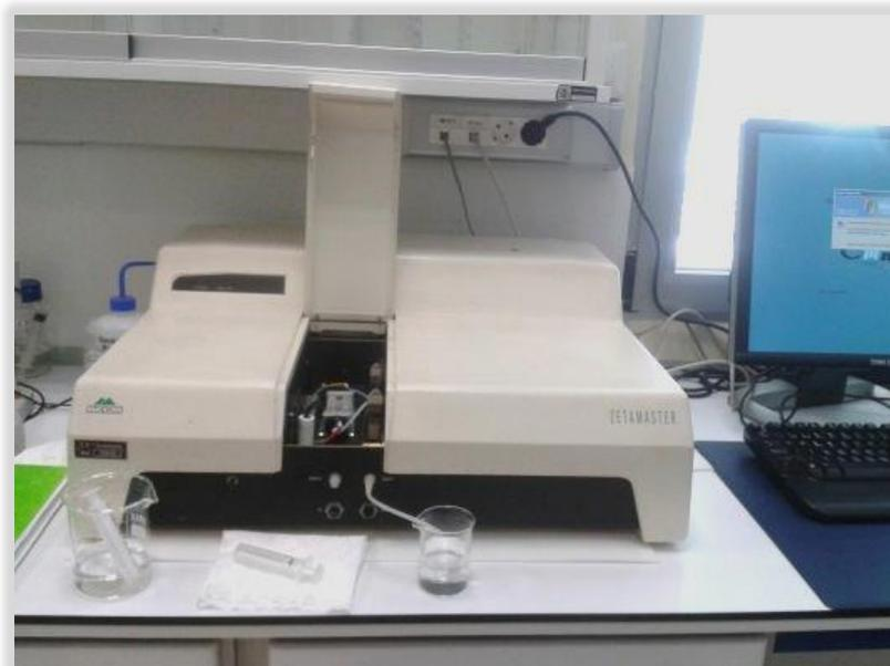
**Figura II.4.** Equipo utilizado para la medida de potencial- $\zeta$  (Malvern Zetamaster).
