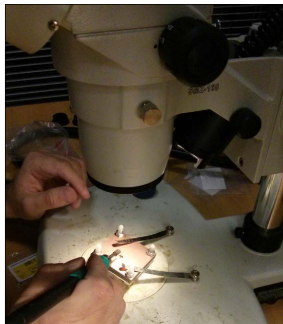
Figura 9-72: Proceso de soldadura
