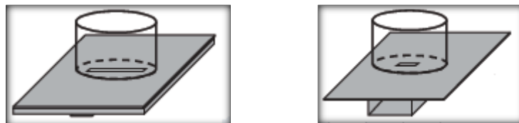
Figura 4-3: Acoplamientos por apertura
