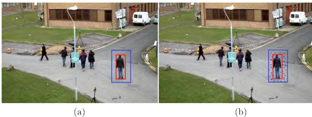
Figura 2-5: Métodos de predicción de movimiento: a) Búsqueda exhaustiva, b) Búsqueda selectiva (donde los puntos azules representan la selección).
