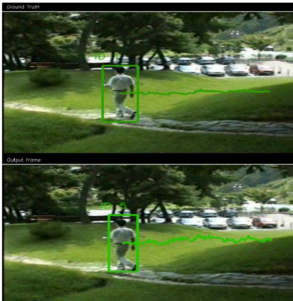
Figura 3-5: Salida visual del ground-truth y del algoritmo de seguimiento de un objetivo.
