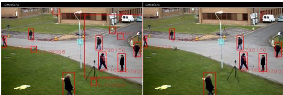
Figura 5-3: Ejemplo de una imagen de la salida del detector de personas Latent SVM para un umbral de confianza de la detección de -0.598 (izquierda) y 0.098 (derecha).
