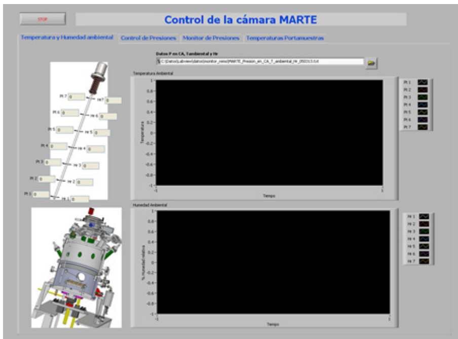
FIG 8.3: Pantalla de inicio del software realizado con Labview® de monitorización y control de los principales parámetros de la cámara MARTE.
