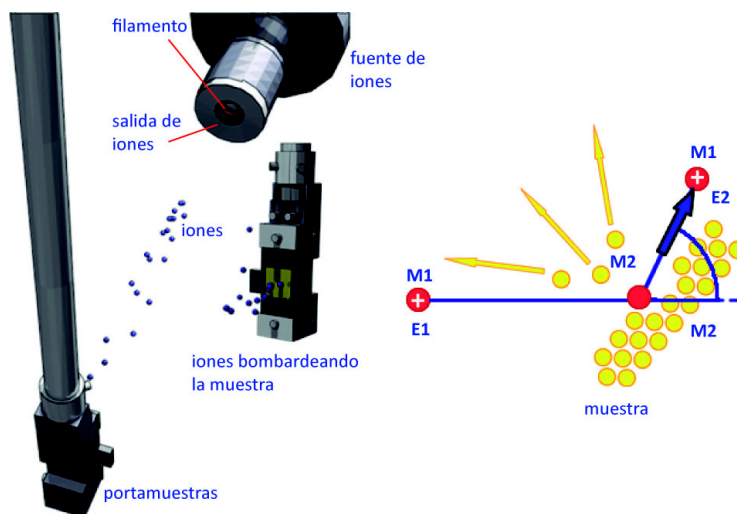
FIG 5.42: Izquierda: Esquema del proceso de bombardeo de una superficie mediante iones de Argón en un sistema de UHV. Derecha: Detalle del proceso de bombardeo (scattering). M1, E1 y E2 corresponden al Argón y M2 al Cobre y contaminantes.
