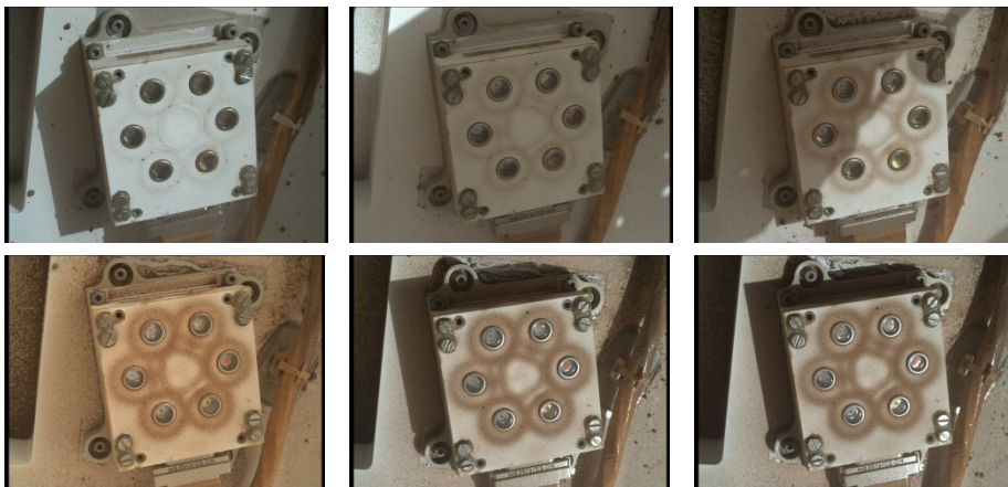
FIG 6.36: (Créditos: NASA/JPL-Caltech/MSSS). Fotografía del sensor UV del REMS. De izquierda a derecha y de arriba a abajo, imagen del Sol (día Marciano) 36, 81, 154, 282, 418 y 526. Se aprecia que la deposición del polvo es mayor a medida que aumentan los días del Curiosity en Marte.
