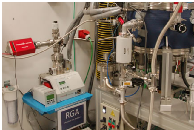
FIG 3.8: Fotografía de la cámara MARTE y del RGA en su configuración de bombeo diferencial.
