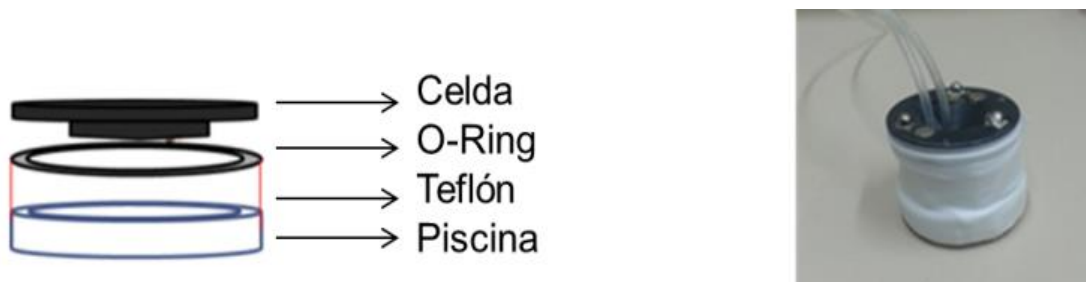
Figura 2.3 a) Representación esquemática de un sistema cerrado de celda líquida, con los componentes que la forman b) Imagen del sistema cerrado utilizado durante este trabajo
