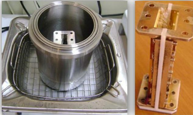
Figura 17. Reactor utilizado para la depositar plata microestructurada mediante reducción auto-catalítica.
