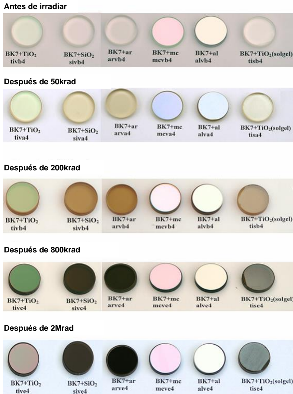
Figura 3.28. Aspecto de los recubrimientos analizados antes y después de la exposición a la radiación gamma. Nota: el sustrato de todos los recubrimientos de las muestras de la imagen es NBK7 .
