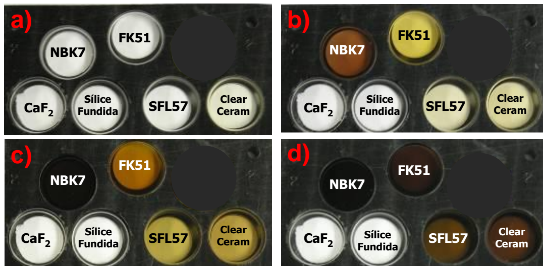
Figura 4.19. Vidrios a) antes de la irradiación con protones , b), c) y d) después de la irradiación con protones, b) dosis total de 50krad , c) dosis total de 200krad y d) dosis total de 800krad .
