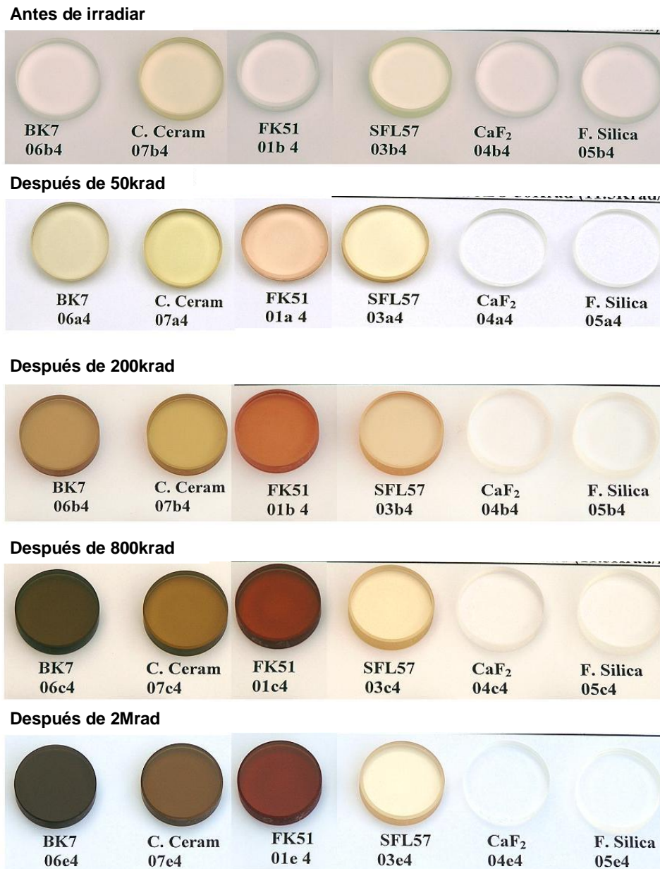
Figura 5.7. Aspecto de los vidrios analizados antes y después de la exposición a la radiación gamma. A la izquierda el vidrio NBK7 , el vidrio más oscurecido por la radiación. A la derecha de la imagen los vidrios que no presentan oscurecimientos.
