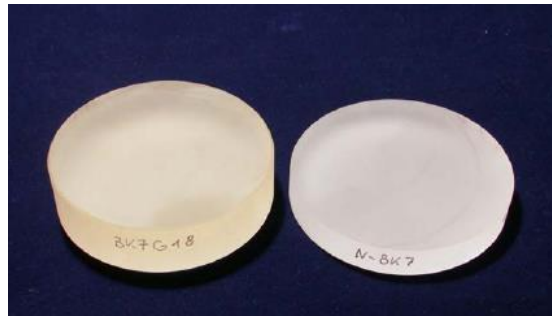
Figura 5.20. Comparación de aspecto visual de un vidrio BK7G18 dopado con cerio (izquierda) y el mismo vidrio sin dopar BK7 (derecha). (Imagen procedente de Schott).
