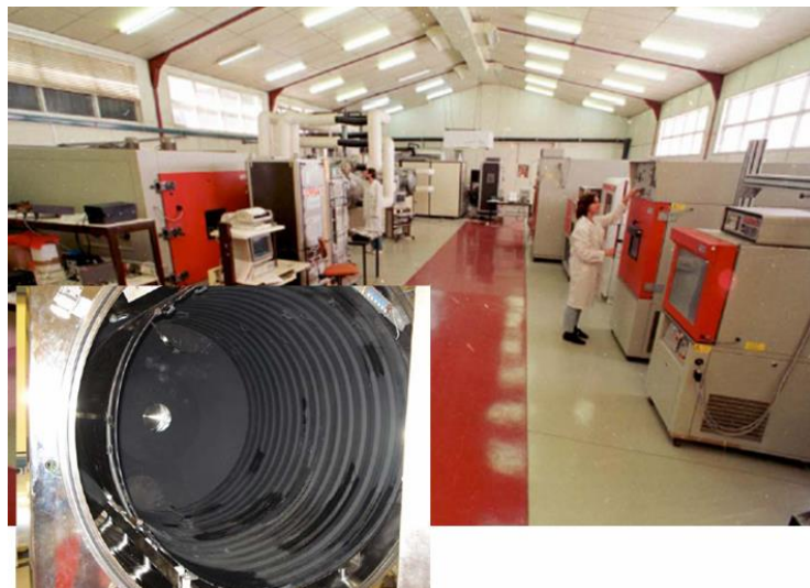
Figura 7.15. Instalaciones de cámaras de vacío y térmicas del INTA e interior de la cámara de vacío (esquina inferior izquierda).
