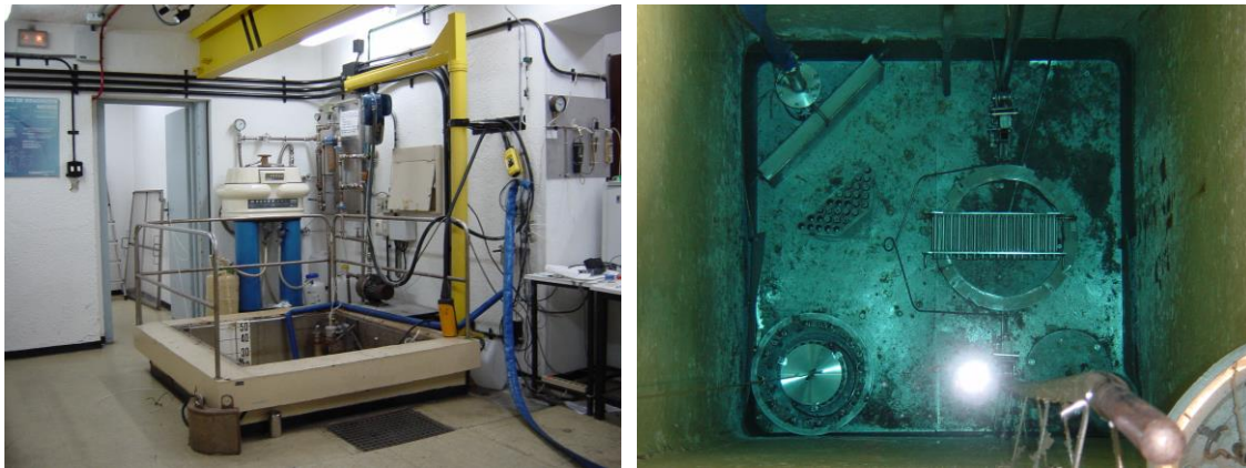
Figura 2.15. Instalación para irradiación gamma NAYADE (CIEMAT) y vista superior del tubo sumergido con las fuentes de cobalto.
