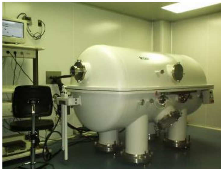
Figura 2.6. Cámara de Vacío y Ciclado Térmico del LINES
