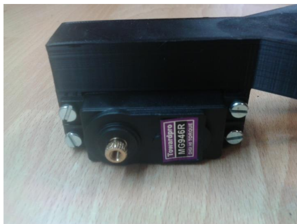
Figura 4.6. Integración de actuador en fémur y tibia.
