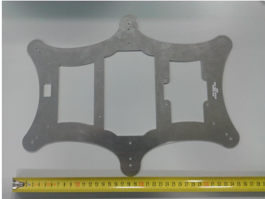
Figura A.4. Pieza fabricada para el cuerpo.
