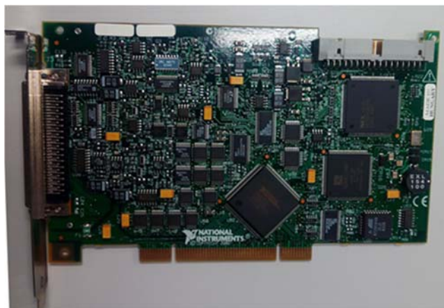
Figura 3.1. Tarjeta de Adquisición de datos similar a la utilizada en el desarrollo del proyecto. Esta imagen corresponde a la tarjeta de un PC fuera de servicio del laboratorio del GNB
