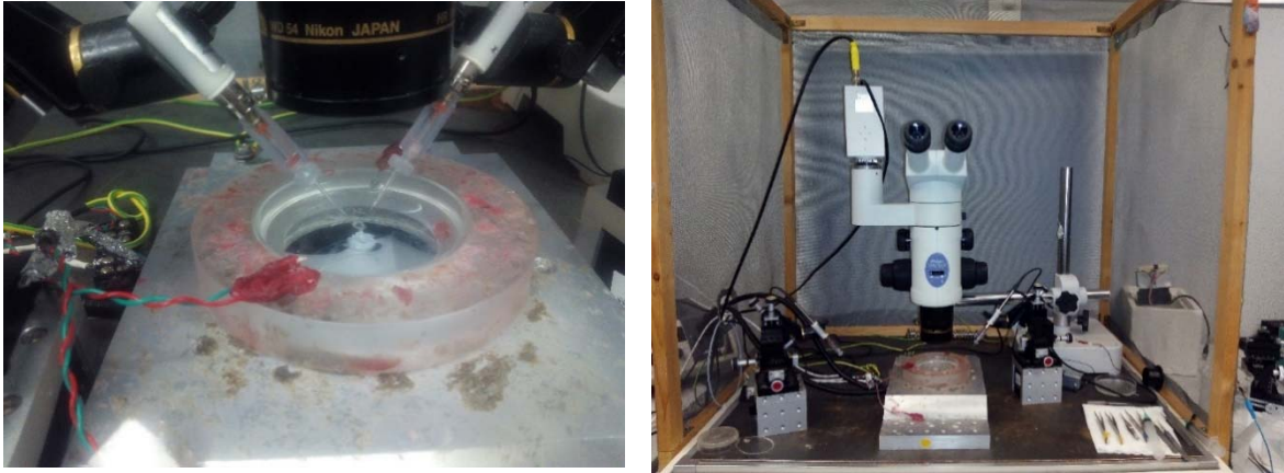
Figura 3.5. La imagen de la izquierda presenta la preparación in vitro de la muestra del sistema nervioso extraída del Carcinus maenas bajo el microscopio de electrofisiología. Se observan dos electrodos conectados a la muestra. La imagen de la derecha muestra el microscopio de electrofisiología del laboratorio del GNB, bajo él se encuentra la muestra del sistema nervioso conectada a los electrodos.
