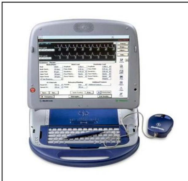
Figura 15.- Programador del Holter Insertable.
