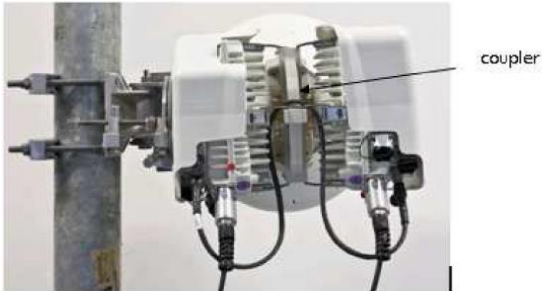
Figura 24. Equipo acoplador de la compañía Alcatel-Lucent
