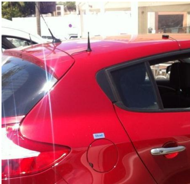
Figura 58. Antena instalada en el vehículo que llevará a cabo las medidas
