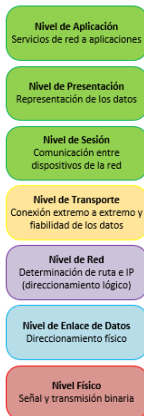
Figura 28. Pila de capas o niveles del modelo OSI (Open System Interconnection)
