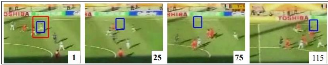
Figura 3.4: Varios frames de una secuencia cuyo algoritmo de seguimiento es el BWH. Como se puede apreciar, en el frame 25 ya se deja de detectar al objeto. Extraído de [40].
