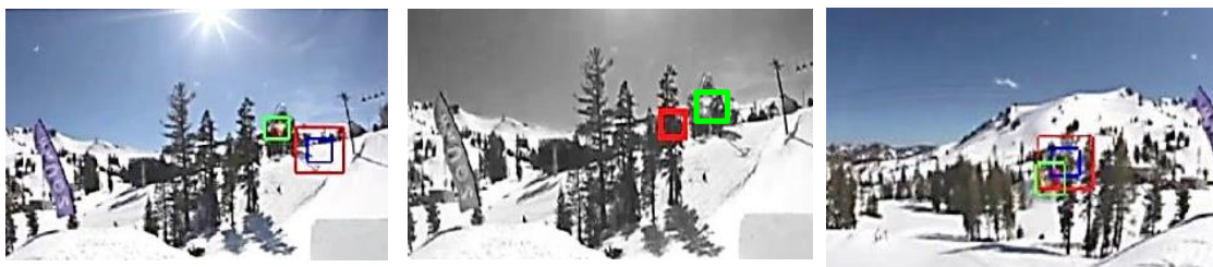
Figura 5.9: Ejemplos donde los distintos trackers comienzan a perder al objeto. De izquierda a derecha se muestran los frames 12, 12 y 43 para los trackers MS, AFS y CBWH respectivamente. El rectángulo verde representa el ground-truth y los rectángulos azules para MS y CBWH, y el rojo para AFS, la posición estimada del objeto.
