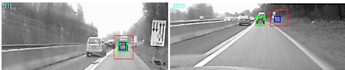
Figura 5.34: Ejemplos de los resultados del tracker MEEM durante varios frames para la secuencia Volkswagen. De izquierda a derecha, en el frame 1511 el algoritmo sigue correctamente al objeto; en el frame 2033 confunde el objeto de interés con la señal y a partir de ese momento y para el resto del vídeo el algoritmo falla. El rectángulo verde corresponde al ground-truth y el azul a la posición estimada del objeto.
