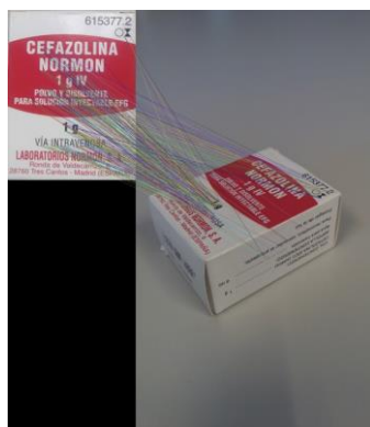
Figura 4-16: Resultado de ejecutar el algoritmo Feature Matching variando la posición de la caja del medicamento
