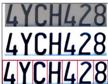
Figura 4-17: Resultado de aplicar la técnica OCR en la matrícula de un vehículo
