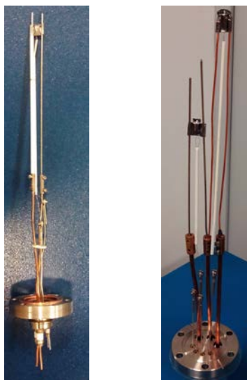
Figura 11. Evaporadores de moléculas empleados en el laboratorio del centro de Astrobiología. (Izquierda). Evaporador con un único sobre de tantalio para la evaporación de una única molécula. (Derecha). Evaporador con dos sobres de tantalio empleado para evaporar dos moléculas sobre la misma superficie).
