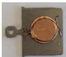
Figura 9. Portamuestras utilizado en los experimentos, superficie de Cu (110).
