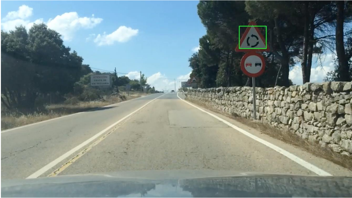
Figura 4-10: Detección de triángulo (interior) preparado para ser candidato en fase de reconocimiento.
