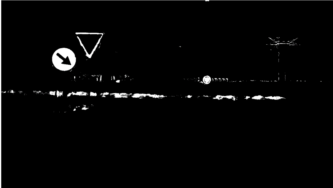
Figura 4-6: Detección de colores azul y rojo sobre figura 4-3.
