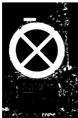
Figura 4-4: Detección de color rojo sobre figura 4-1.
