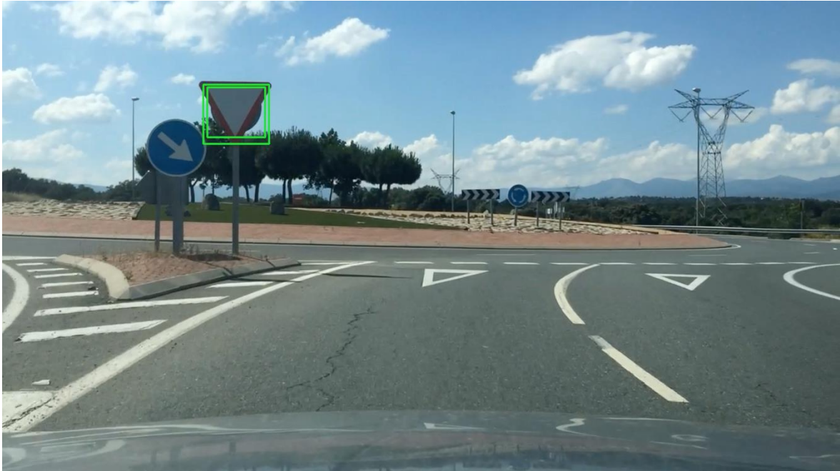
Figura 4-12: Detección de triángulo (interior y exterior) preparados para ser candidatos en fase de reconocimiento.
