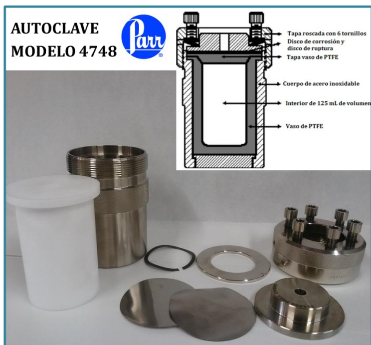
Figura 3.1. Autoclave Parr empleado en la síntesis solvotérmica de los fotocatalizadores de CdS.
