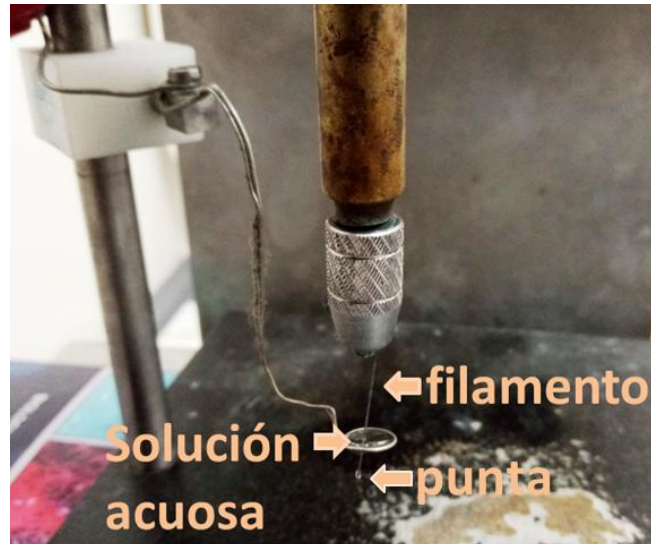
Fig.2.4.4. Procedimiento electroquímico realizado para la obtención de puntas de STM.
