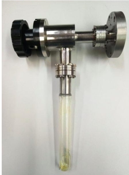
Fig.2.3.2. Sistema de evaporación de las moléculas: crisol de cuarzo y válvula.
