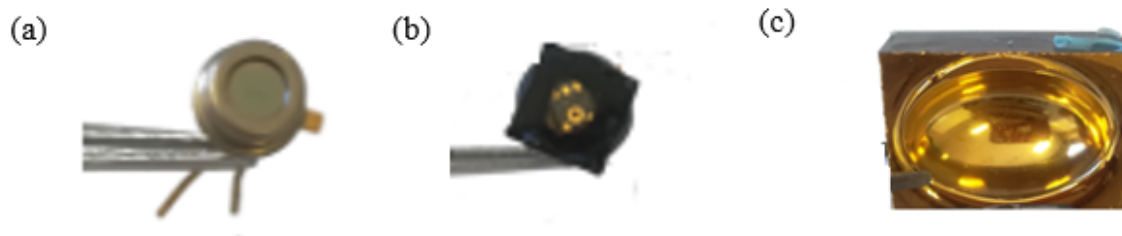
Figura 3.4: En esta figura se muestra el LED (a), cápsula receptora (b) y cúpula (c) que conforman el sensor de CO 2
