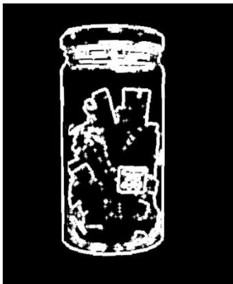
Figura 5-5: Detección ideal del recipiente en imagen en tiempo real
