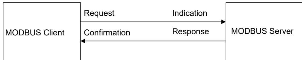
Figura 2.3: Comunicación en Modbus TCP [1]
