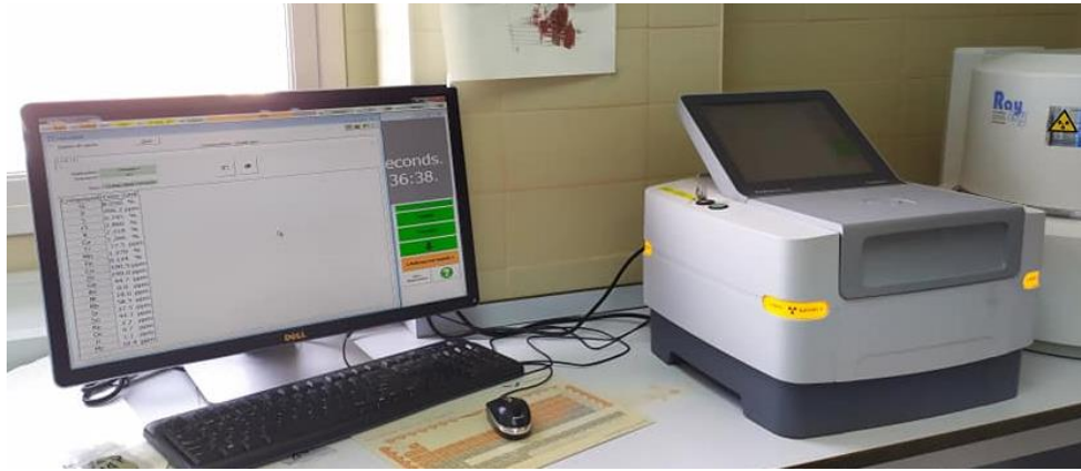
25. Equipo de espectroscopia de fluorescencia de rayos X por dispersión de energía (ED-XRF), en el Instituto de Geología Aplicada (IGeA), Almadén, España.
