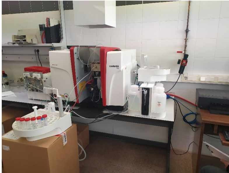
27. Equipo de espectroscopía de absorción atómica de alta resolución (HR-AAS), en la Escuela Técnica Superior de Ingenieros Agrónomos de Ciudad Real, España.
