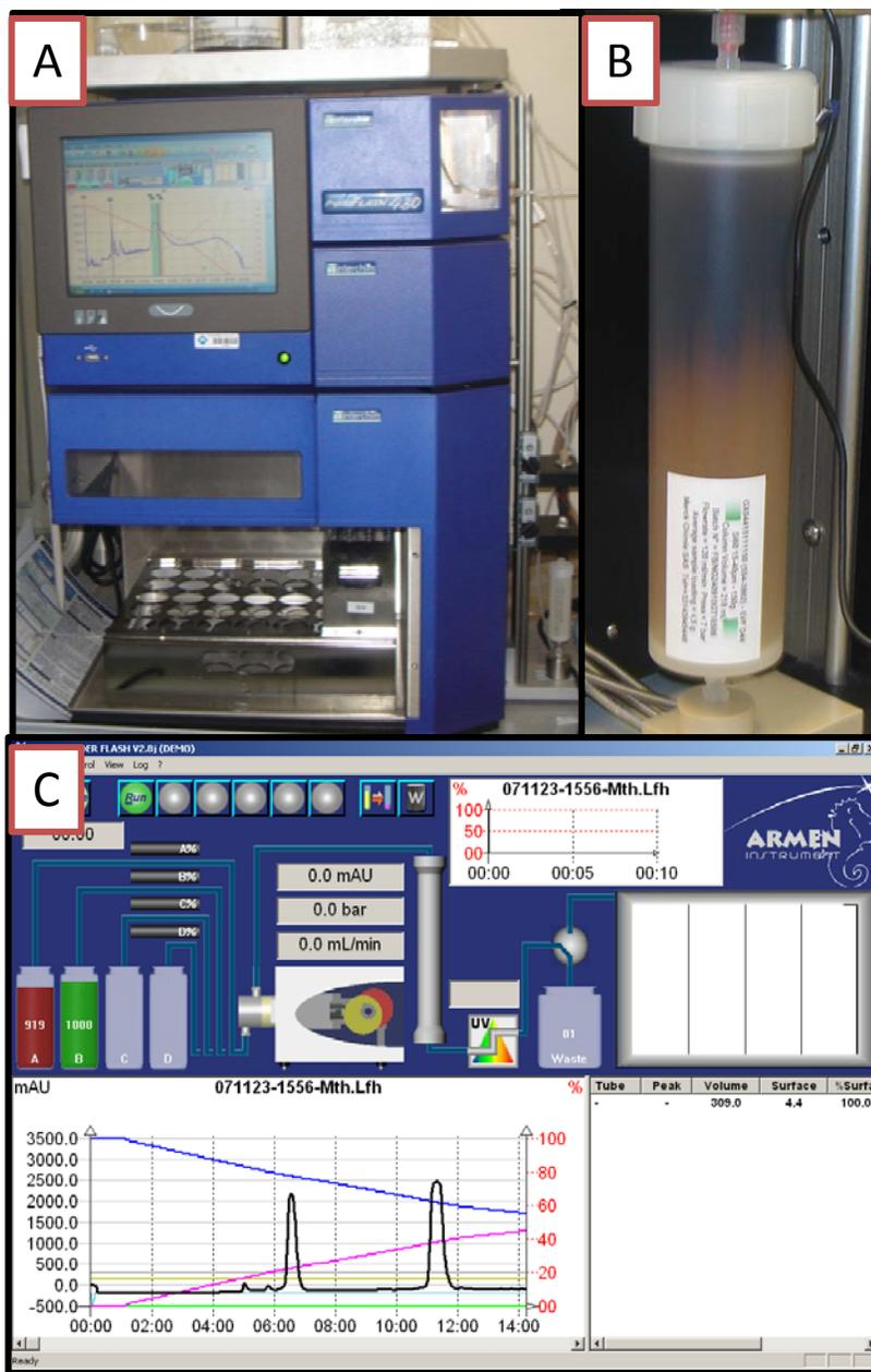
**Figura 6:** Fotografías de: a) un sistemas automatizado de purificación a baja presión en fase normal, b) de cartuchos pre-empaquetados de sílice y c) la pantalla de control del instrumento donde se observan el cromatograma generado, la composición del gradiente y otros datos de interés como la presión del sistema.
