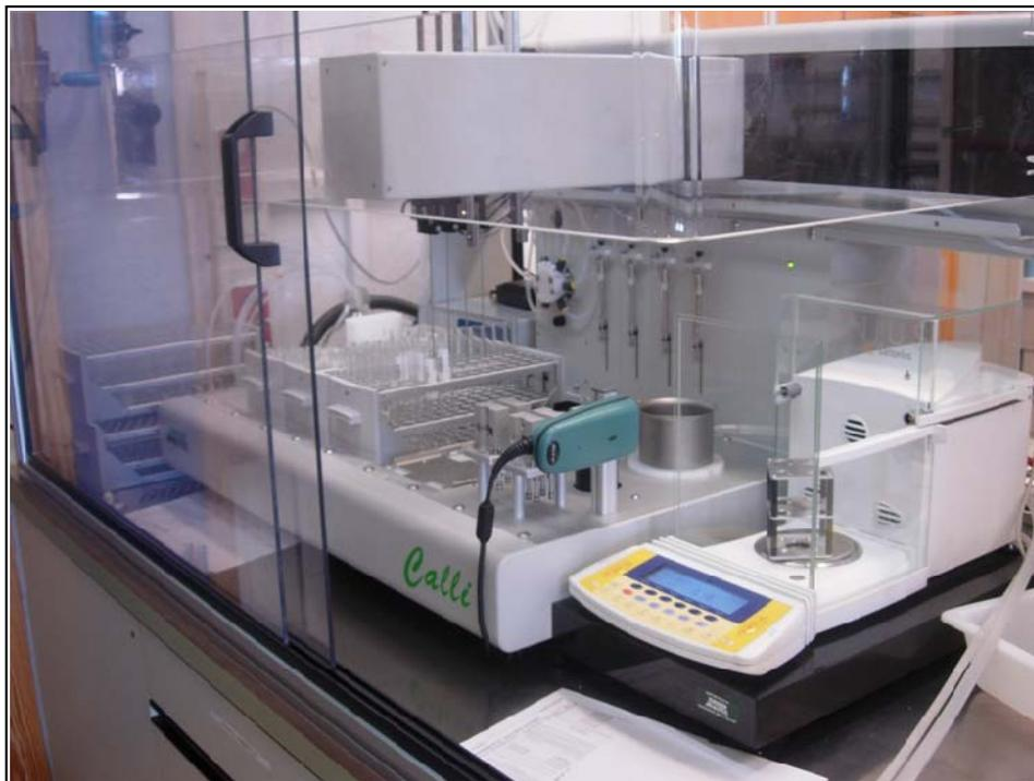
**Figura 50:** Fotografía del instrumento Calli LH de Zinsser utilizado en este trabajo.
