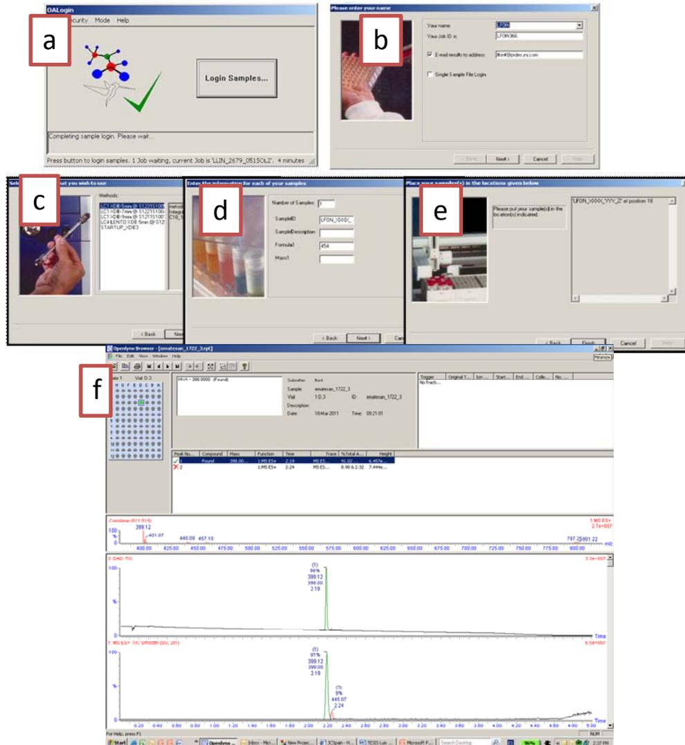
**Figura 4:** Pantallas de Openlynx para: a) iniciar el proceso de programación de la muestra, b) hacer la entrada del nombre de usuario, c) la selección del método analítico, d) la entrada del nombre de la muestra y por último e) la asignación por parte del software de la posición de inyección. En la parte inferior, f) información que recibe el usuario en el correo electrónico y que se visualiza en OpenLynx Browser.
