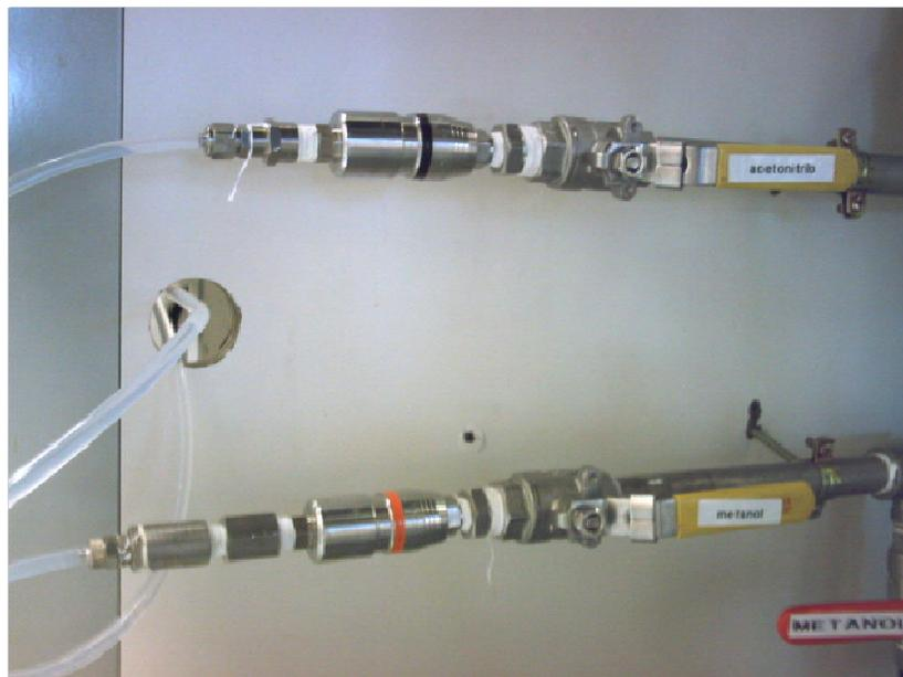
**Figura 20:** Detalle de la conexión, en el laboratorio, de las tuberías de las bombas de HPLC preparativas a la línea de disolventes.
