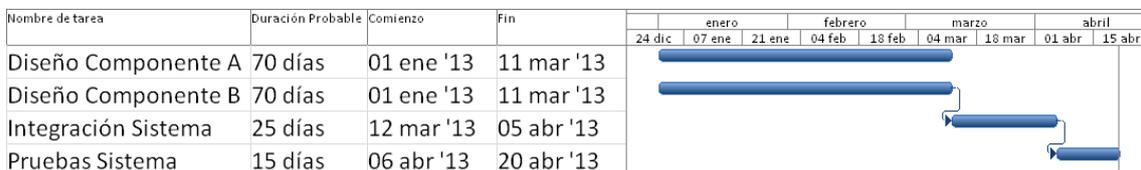
Figura 122. Ejemplo de lógica incompleta, *Diseño Componente A* sin un sucesor
