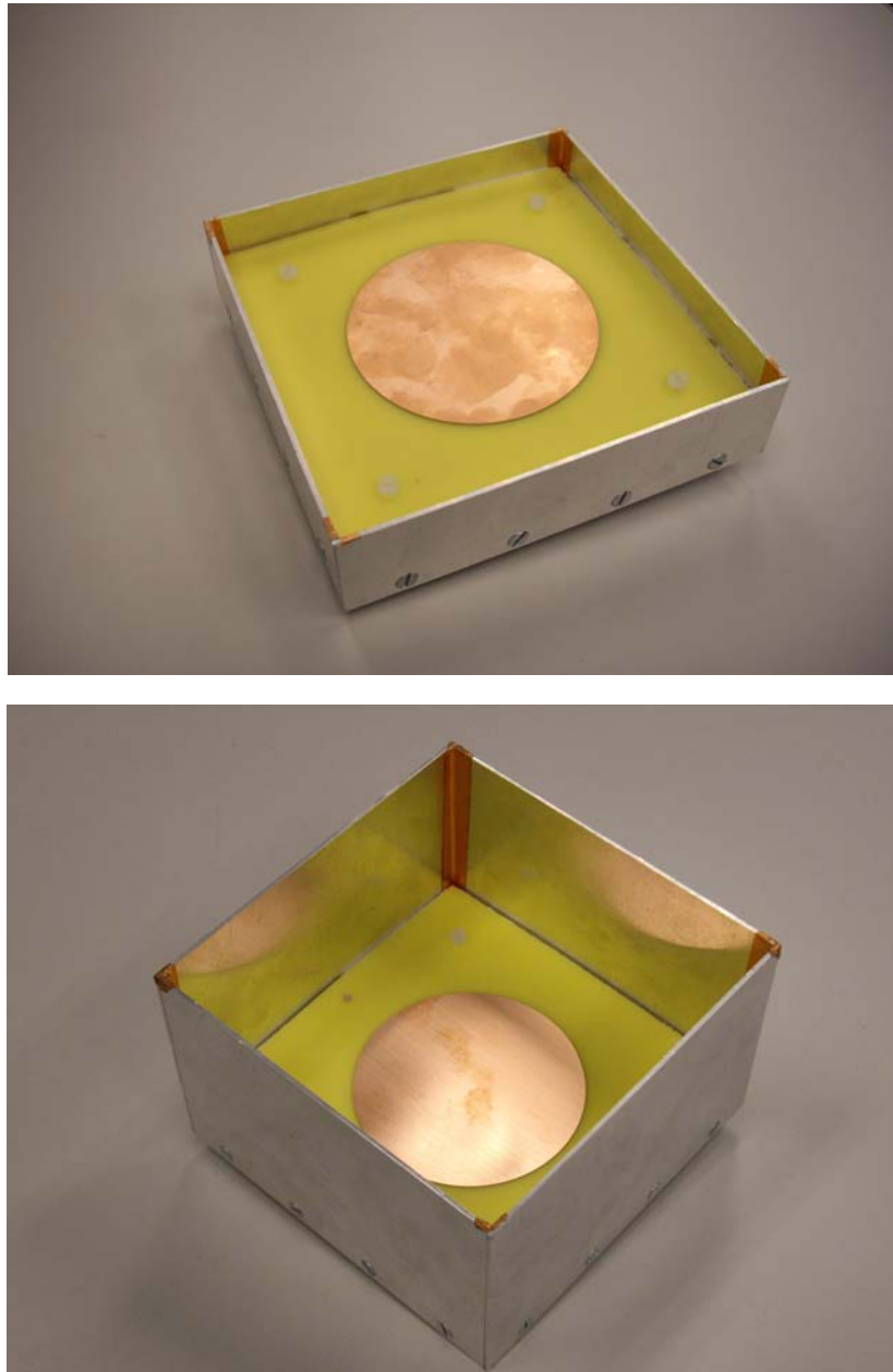
Figura 4.87 – Imagen del elemento radiante individual ensamblado, de cavidad baja (arriba) y de cavidad alta (abajo)
