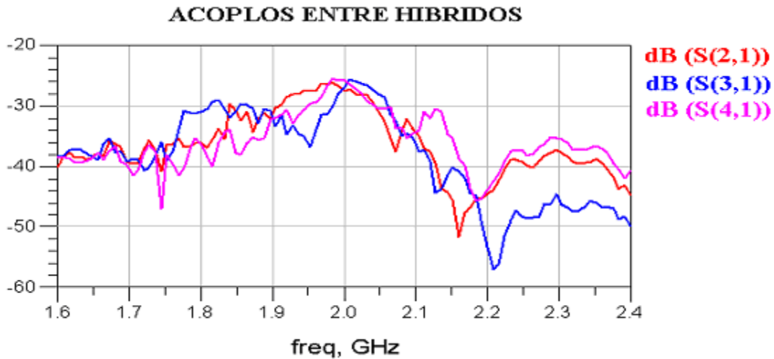
Figura 8.59 – Acoplos entre los híbridos del array de 0.5\lambda de altura y alimentación rotada
