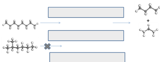
Figura 1.4. Esquema ilustrativo de la selectividad de forma de los materiales zeolíticos a los reactivos (craqueo preferente de hidrocarburos lineales).
