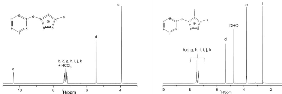
Figura 3.3. RMN de ^1\text{H} de los cationes 1B3MI en \text{CDCl}_3 (izquierda.) y 1B23DMI en \text{D}_2\text{O} (derecha).
