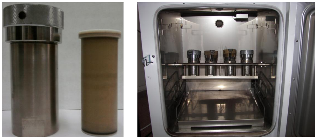
Figura 3.15. Autoclave de acero inoxidable y vasija de teflón (izquierda) y estufa con gradilla móvil (derecha).
