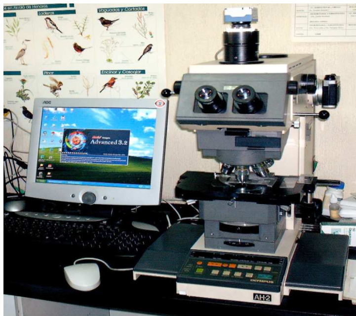
Figura 15. Microscopio óptico acoplado al sistema de análisis de imagen.
