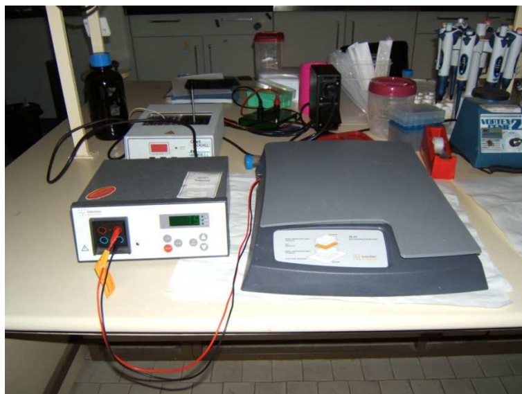
Figura 12. Cubeta de transferencia conectada a fuente
