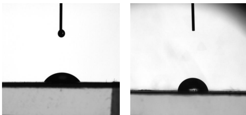
Figura III.10: Medida de ángulo de contacto para un material hidrófilo (Izq.) y un material ligeramente hidrófobo (Dcha.).
