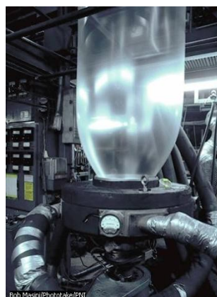
Figura III.2: Detalle de un extrusor genérico (Izq.) y de un dispositivo de extrusión y soplado (Dcha.).
