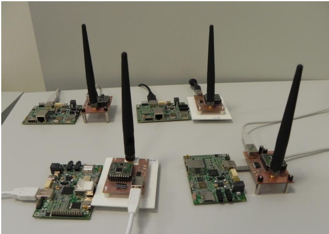
Figura 3-1: Cuatro nodos fijos. IGEPv2 y módulos de RF
