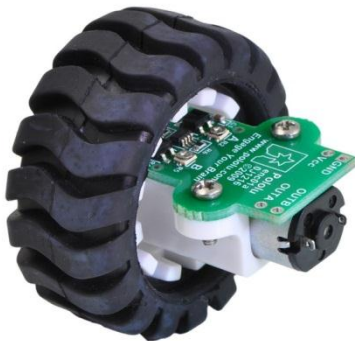
Figura 3-36: Pack motor, rueda y encoder de cuadratura.
