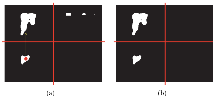
Figura 3.13: Ejemplo del procedimiento de eliminación de ruido. En la imagen (a) se representa la imagen original, dividida en cuadrantes y el centroide del tercero proyectado verticalmente en el primero de ellos. En la imagen (b) se muestra la silueta final observada tras el proceso de eliminación de ruido.
