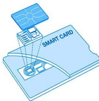
Figura 2- 1: Composición de una tarjeta inteligente con contactos.
