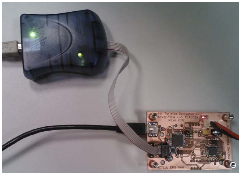
Figura C- 1: Conexión del lector al programador, PC y alimentación.
