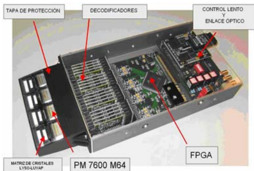
Figura 3.28: Módulo independiente detector conteniendo las 4 matrices FM/centellantes y la electrónica de lectura
