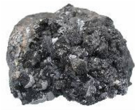
Fotografía (4.11): Fotografía de la wurzita y esquema de bolas de su estructura cristalina hexagonal.
