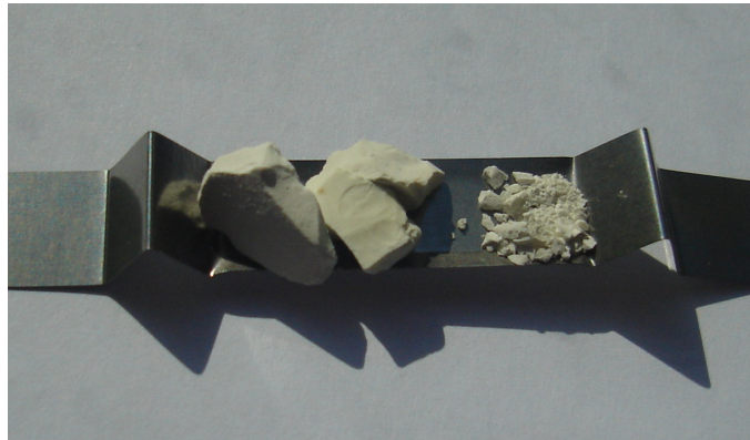
Fotografía (4.12): Fotografía del ZnS comercial (a la izquierda) y el material preparado para la evaporación.
