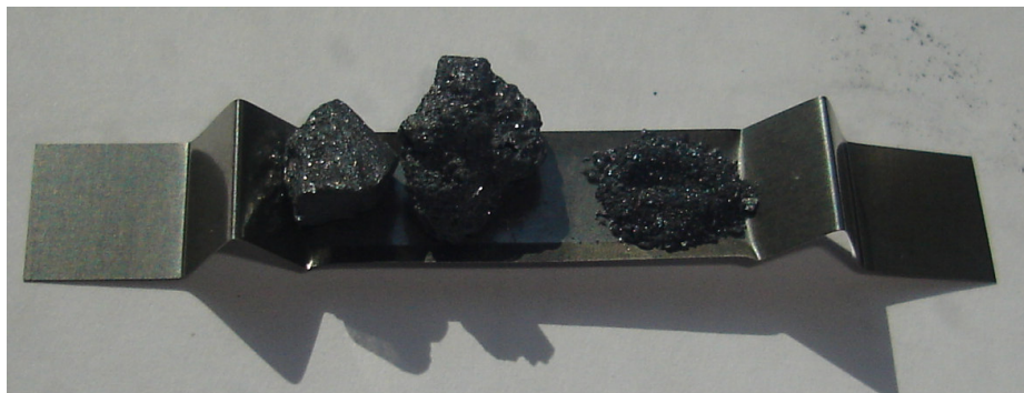
Fotografía (4.15): Imagen del \text{Sb}_2\text{S}_3 comercial (a la izquierda) y machacado para la evaporación (a la derecha).
