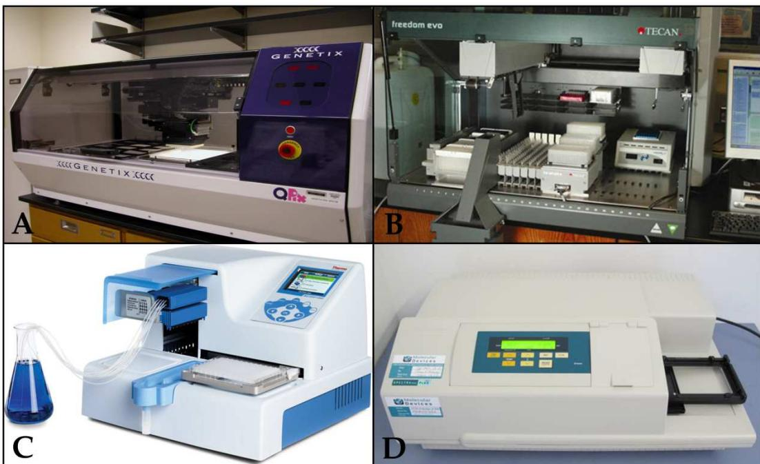
**Figura 1.4.** Ejemplos de herramientas HTS utilizadas en experimentos de evolución dirigida. (A) Robot picador de colonias. (B) Robot manipulador de líquidos. (C) Robot dispensador de líquidos. (D) Lector de microplacas.
