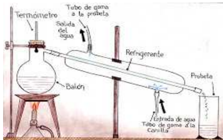
Ilustración 4: Esquema de la destilación simple
