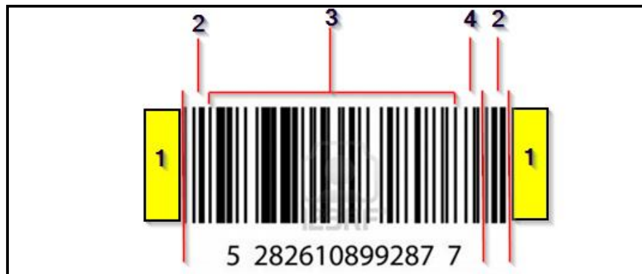
Figura 2- 5 Estructura General de un Código de Barras
