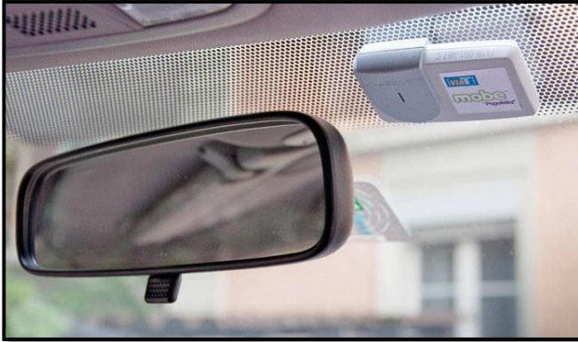
Figura 2- 3 Sistema RFID aplicado al Telepeaje (Izquierda); Funcionamiento RFID aplicado al Telepeaje (Derecha)
