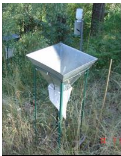
Fotografía 1.1: Detalle de un recogedor de desfronde.
