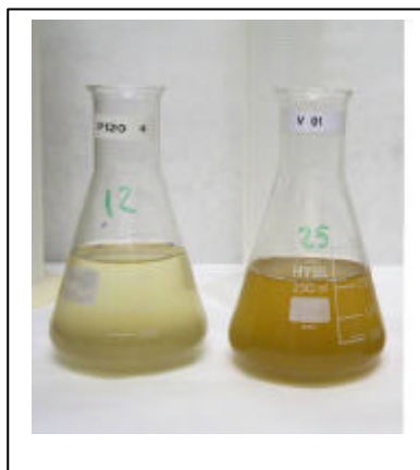
Fotografía 14: Color de lixiviados al inicio del ensayo, en compost de restos de poda+biosólidos (derecha) y compost de corteza de pino (izquierda).
