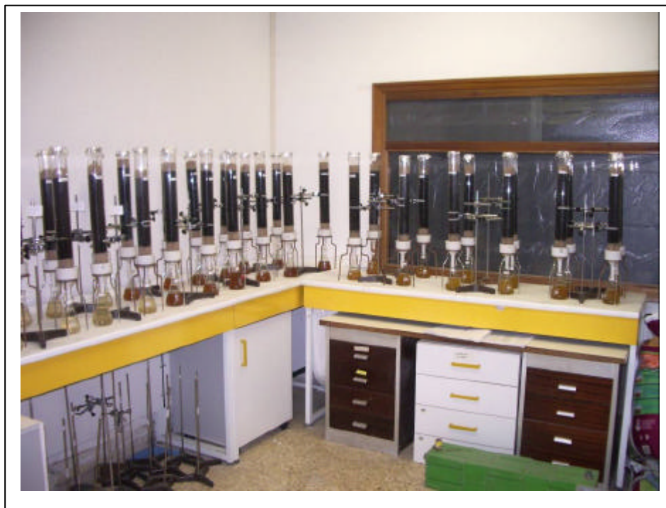
Fotografía 1: Columnas para estudiar lixiviación (Eymar et. al, 2002).
