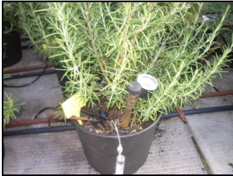
Fotografía 11: Rosmarinus officinalis . Control de humedad con tensiómetro y de la solución nutriente del sustrato de mediante sondas de succión rhizon.
