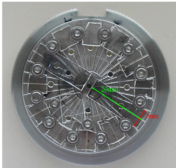
Figura 2.7: Fotografía del portamuestras con cristales de \text{LiNbO}_3 fijados a su superficie, para ser irradiados. Se indican las dimensiones de una de las muestras.
