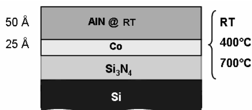
Fig. 3.3.1. Esquema de los espesores nominales y temperaturas de deposición de las muestras presentadas
