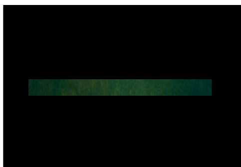
Fig. 5 Imagen por fluorescencia del área sensora de la Figura 6 del MZI a) una vez lavado con disolventes orgánicos, tratado con plasma de O_2 y con HNO_3 en agua destilada caliente a 75^\circ C para eliminar la monocapa del oligonucleótido 916delTT-Cy3 inmovilizada. A continuación es inmovilizada la misma concentración del oligonucleótido 916delTT-Cy3 1 \mu M. b) Tratados y lavados de nuevo por el proceso anterior y silanizados (por segunda vez) para obtener una nueva monocapa de silano y luego así inmovilizar el oligonucleótido 916delTT-Cy3. Las imágenes en intensidad de fluorescencia sobre el área sensora son muy ténues.
