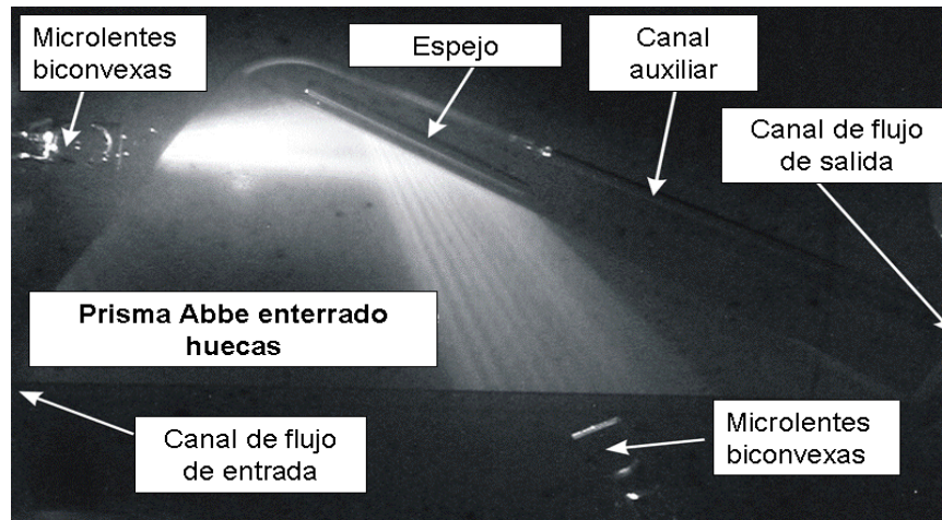
Fig. 3 Ejemplo de micros sistema total de análisis con elementos pasivos ópticos. A. Llobera et al. Lab Chip , 2005, 5, 506-511
