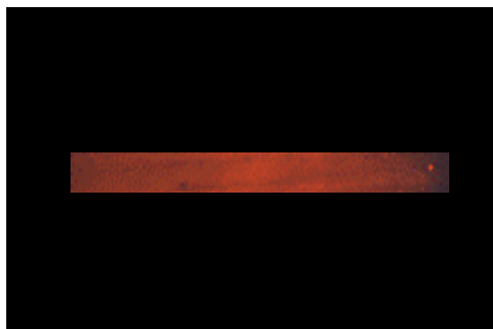
Fig. 4 Imagen de fluorescencia para la inmovilización del oligonucleótido 916delTT 1 \mu M en el área sensora
