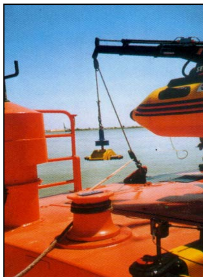
Fig. 4.1.- Draga Shipek utilizada para la toma de muestras de sedimento.
