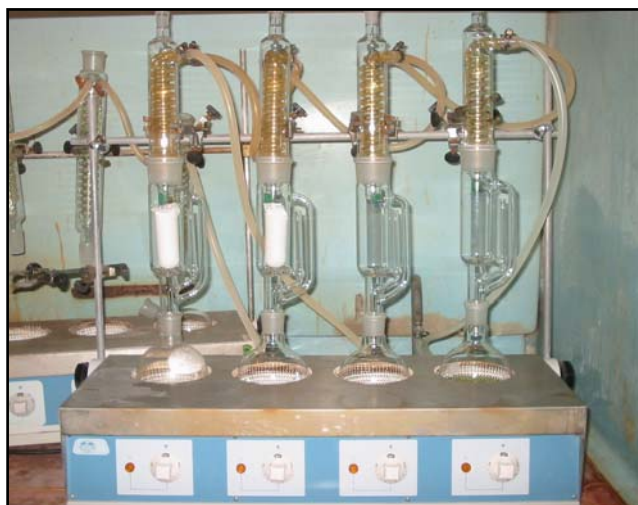
Figura 4.7.- Sistema de extracción a reflujo Soxhlet.
