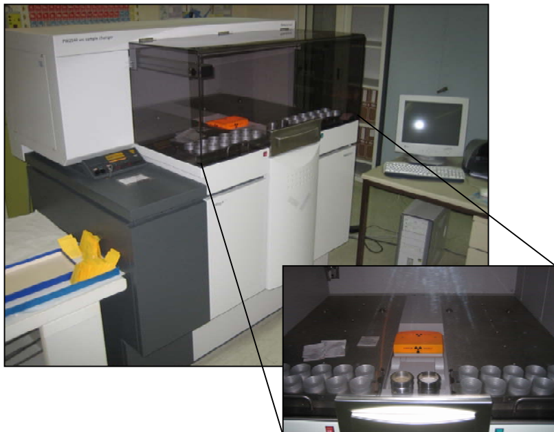
Fig. 4.3.- Equipo de FRX utilizado para el análisis de los componentes mayoritarios (Panalytical MagiX).
