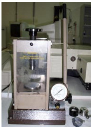
Fig. 2.18. Prensa para pastillar Spelac y matriz Termo Die Model 129
