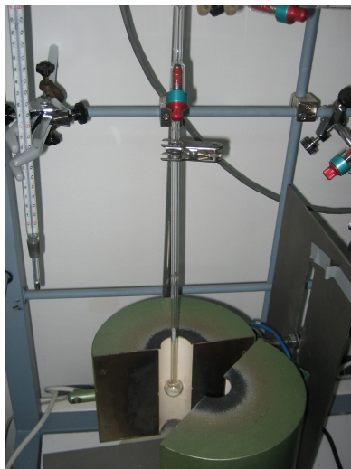
Fig. 2.15. Detalle del bulbo de adsorción donde se aloja la muestra.
