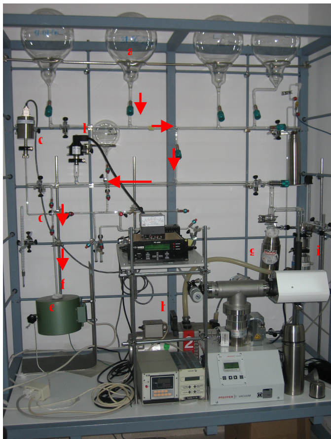
Fig. 2.13. Equipo de vacío: a) balones que contienen los gases, b) medidor de vacío, c) medidor de presión, d) volumen calibrado ( V_c ), e) horno eléctrico, f) bulbo de vidrio pyrex ( B_a ), g) trampa de N_2 líquido, h) bomba rotatoria, i) bomba turbomolecular.
