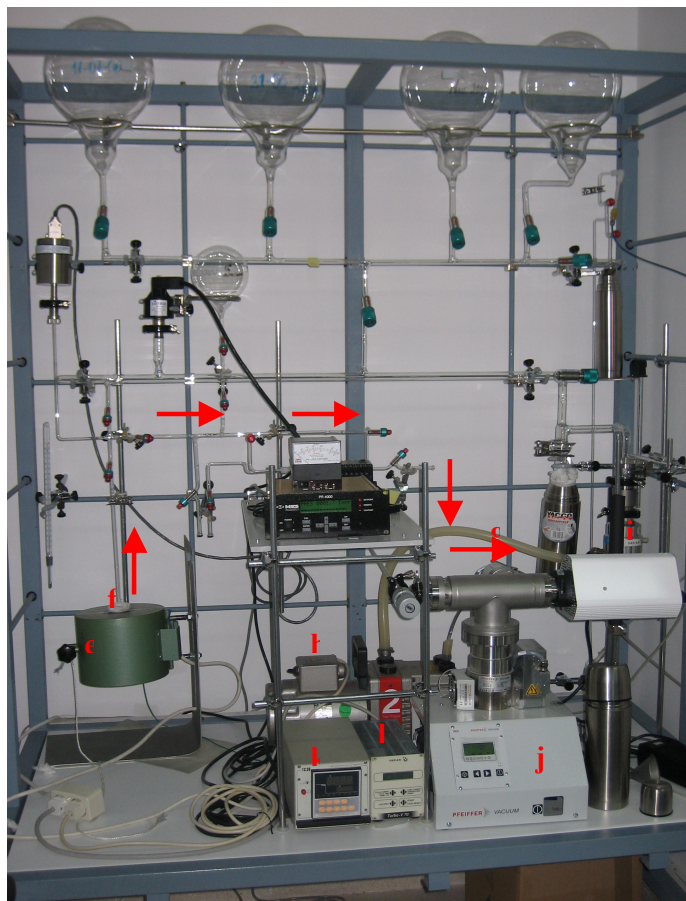
Fig. 2.14. Equipo de vacío: e) horno eléctrico, f) bulbo de vidrio pyrex ( B_a ), g) trampa de N_2 líquido, h) bomba rotatoria, i) bomba turbomolecular, j) espectrómetro de masas, k) controlador de temperatura y l) controlador de presión.
