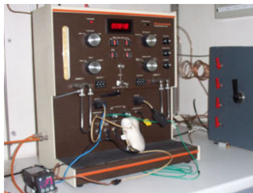
Fig. 2.12. Equipo de quimisorción Pulse Chemisorb 2700 Micromeritics
