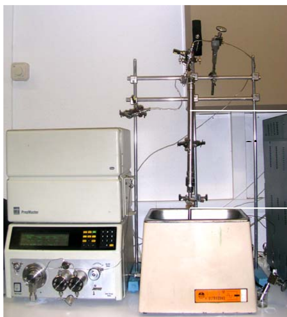
Figura 27: Foto del montaje para el llenado de las columnas preparativas.
