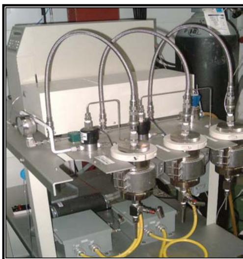
Figura 19: Sistema de recogida de fracciones de la planta de PS-SFC por medio de separadores ciclónicos.
