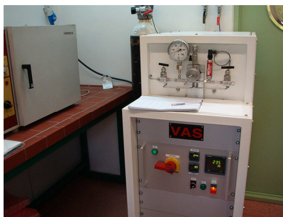
Figura II.2. Horno VAS utilizado para los tratamientos térmicos a alta presión de oxígeno
