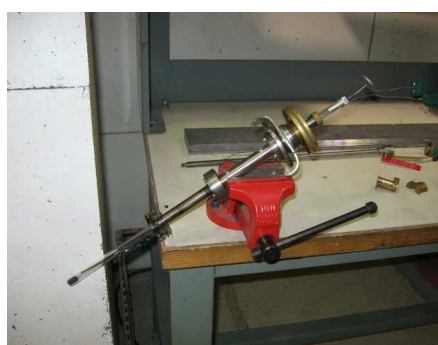
Figura II.5. Portamuestras utilizados: a) portamuestras de vanadio y b) portamuestras de cuarzo
