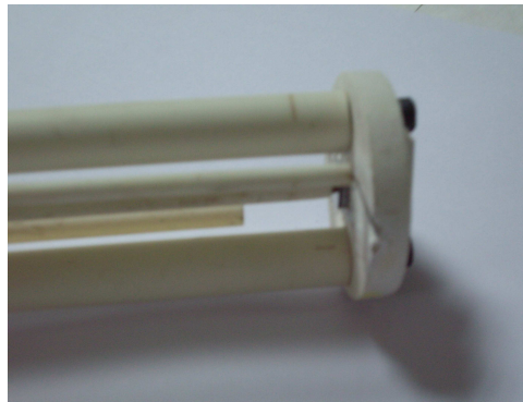
II.22. Cabezal de dos puntas utilizado para las medidas de impedancia compleja
