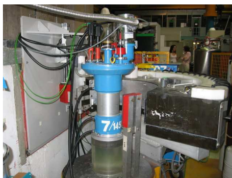
Figura II.6. Horno utilizado para llevar a cabo las medidas de difracción de neutrones a alta temperatura
