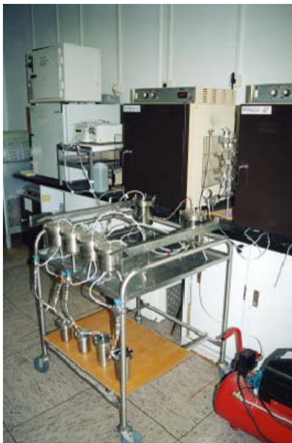
Figura 3.2: Fotografía de los ensayos de percolación.
