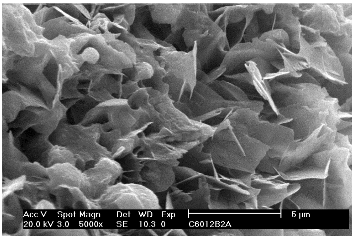
Fotografía 4.16: \text{Ca(OH)}_2 , 60 °C. Interfase con hormigón (cara del hormigón). Aspecto típico de depósito arcilloso con gel-CSH (detalle).
